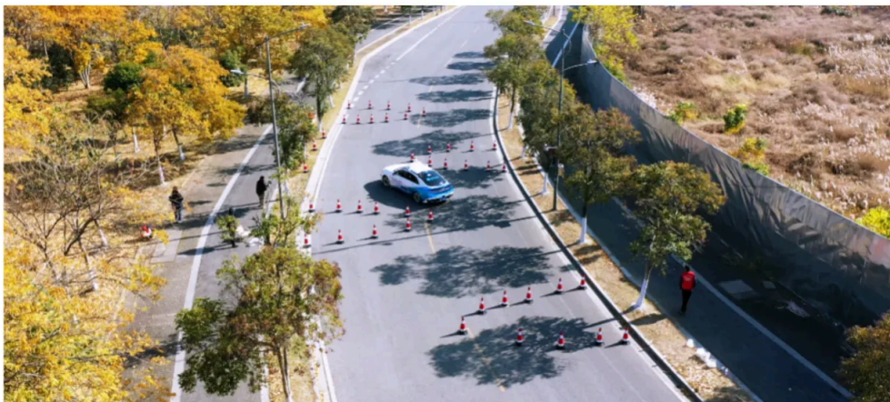
图3 道路施工情况下智能车全自动驾驶能力验证
